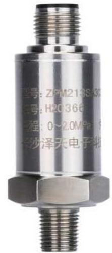
CYB320 工程机械压力变送器采用溅射薄膜压力传感芯片为敏感组件，融合高可靠专用信号处理电路，采用激光焊接精密封装于不锈钢壳体内，组成性能优越的压力变送器。溅射薄膜压力传感采用离子溅射、集成电路光刻工艺直接形成在特种不锈钢弹性膜片上，彻底实现了敏感元件的无机质化，克服了传统有机粘接胶带来的蠕变、滞后、老化等不稳定因素，大大提高了产品的长期稳定性。产品出厂前经过数千次压力疲劳冲击，高低温循环老化和宽温区温度补偿，确保产品稳定可靠。一体化结构，防护性能优越，优良的可靠性、小巧美观的外型、多种接口形式和电气连接，广泛应用于工程机械、液压测试系统、路桥机械，气压设备；桥梁顶升设备、船舶和深海钻井平台；燃油机、内燃机、压缩机、试验机等恶劣环境场合的压力测量。
